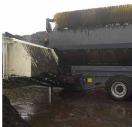
内部へのアクセスが容易な 一枚仕立ての サイドカバー(両側)
