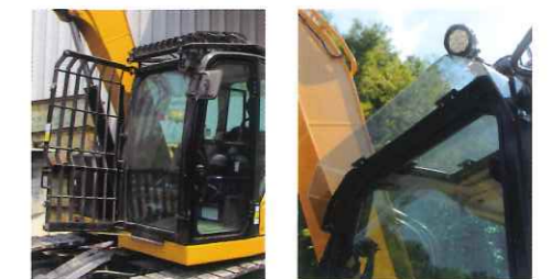
キャブフロントフルガード (格子 開閉式) レインバイザー
