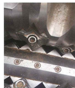
カッターナイフとカウンターナイフの間隙
